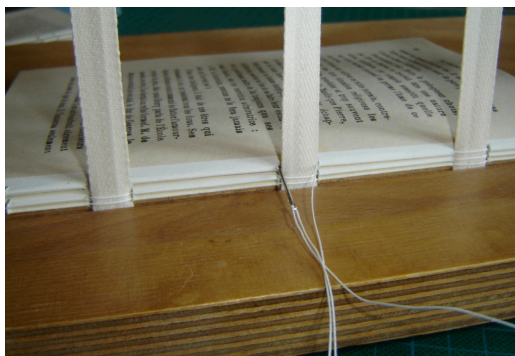
Couture en cours. On peut voir le cousoir en bois sur lequel des supports (ici en ruban) ont été tendus. Le fil et l'aiguille viennent coudre les cahiers de feuille aux supports pour les maintenir solidement ensemble. © Émilie Diné.
