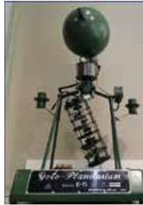
Instrument de projection, planétarium de type opto-mécanique projetant les étoiles, la Lune, le Soleil et les planètes à une date donnée, sous un dôme hémisphérique de 5 mètres de diamètre © Planétarium de Belfort.
